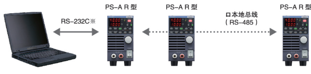
注：在使用 GP-IB 和 USB 连接的情况下，只有第一台需要使用 IF-70GU 型 GP-IB/USB 控制板。
